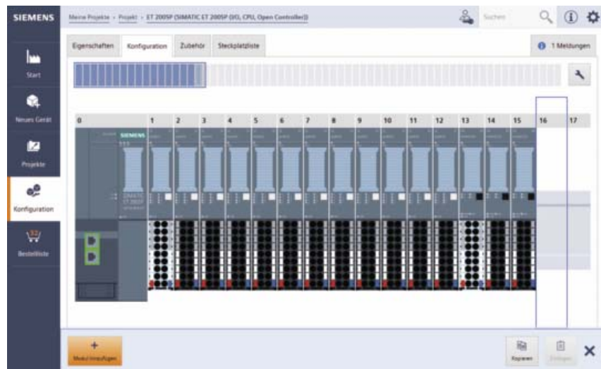
Konfiguration einer ET 200SP über das TIA Selection Tool Cloud
